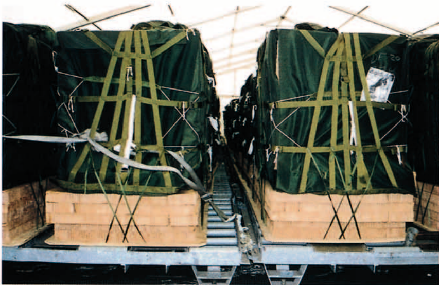
Cargas preparadas para lanzamiento en Alta Velocidad.
