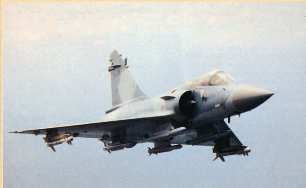
Avión Mirage 2000-5 equipado con cuatro misiles aire-aire MICA de medio alcance y dos MAGIC 2 de corto alcance, ambos de la casa Matra. (Foto Matra Défense /Dassault Aviation).
