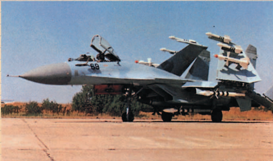
Avión ruso SU-27 K en configuración aire-aire. Se pueden observar dos misiles semi-activos R-27 ER, dos misiles anti-radiación R-27 EE, dos misiles de guiado infrarrojo R-27 T y cuatro misiles R-73.
