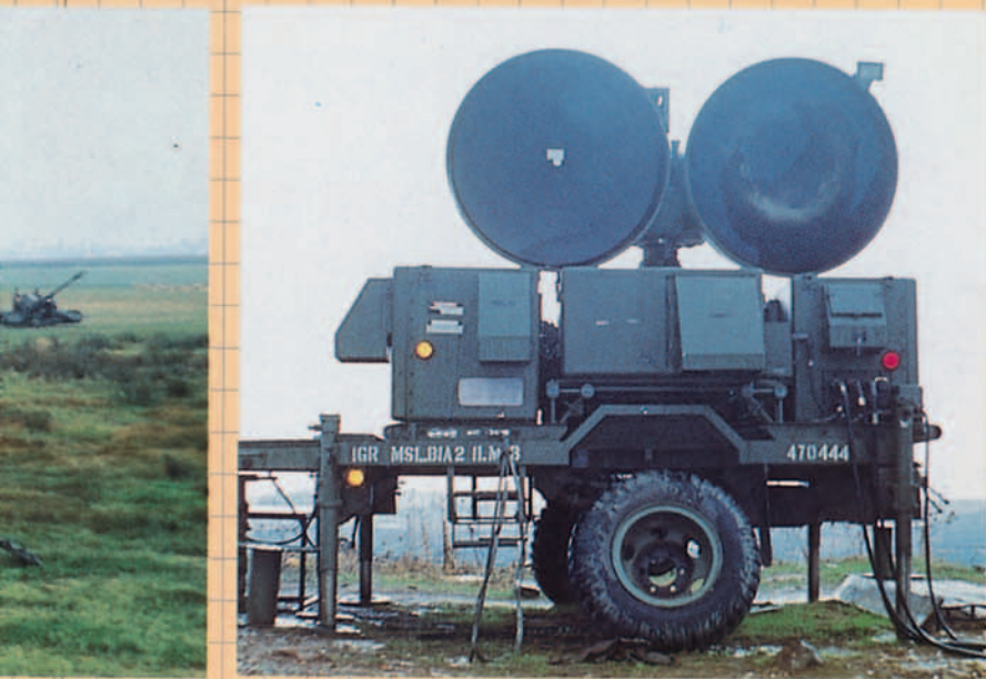
Radar iluminador Hawk.
