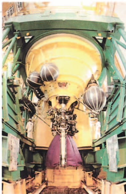
Operación de ensamblaje-integración realizada en la Base Espacial de Kourou en 1994, del motor Vulcain del Ariane 5 al cuerpo central del lanzador. A la derecha puede observarse el depósito esférico de helio líquido y a la izquierda los dos depósitos esféricos de helio gaseoso a alta presión.
