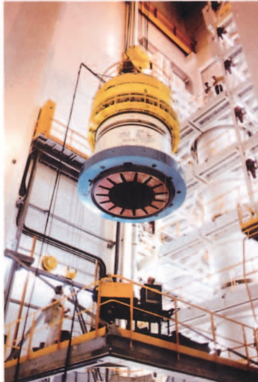
Operación de montaje en Kourou de la parte superior de uno de los dos cohetes de propulsante sólido del Ariane 5.
