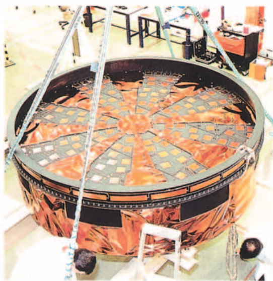
La Plataforma Polar para el ENVISAT, en los ensayos térmicos del comportamiento de las baterías, realizados en el ESTEC (Países Bajos), en la primavera de 1994. ESTEC.-European Space Technical Centre.
