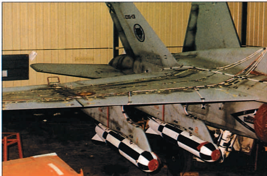
Instalación para pruebas de la bomba española BME-330 en un F-18.
