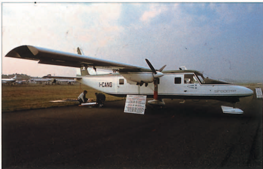
El SIAI-Marchetti SF.600 Canguro voló como prototipo con la matrícula I-CANG el 30 de diciembre de 1978, equipado con motores de pistón Textron-Lycoming T10-540-J. Posteriormente este prototipo se remotorizó con dos turbohélices Allison 250-B17C y así equipado apareció en Farnborough '82 como el SF.600TP.
