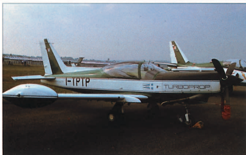
El SIAI-Marchetti SF.260TP es un monomotor cuyo primer vuelo se remonta a julio de 1964. Originalmente equipado con motor de pistón, el SF.260 se convirtió en la versión TP al instalársele un turbohélice Allison 250-B17C. El SF.260 ha sido fabricado en más de 800 unidades y exportado a unos 20 países.
