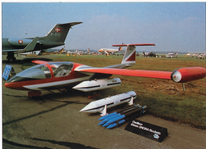
El Caproni Vizzola C.22J, inicialmente concebido como entrenador ligero, compareció en Farnborough'82 provisto de una cierta capacidad de transporte de armamento, con depósitos de punta de ala y dos motores Microturbo TRS 18-1 de 130 kg. de empuje cada uno.
