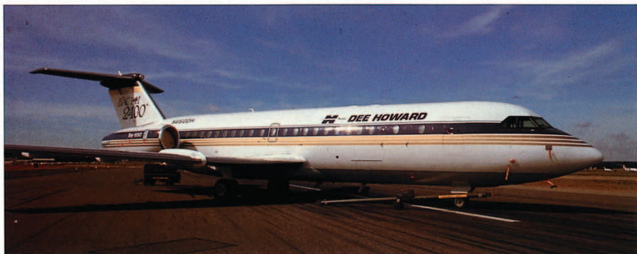
El BAe/BAC 1-11 modificado por Dee Howard Co. (grupo Alenia S.p.A.) y remotorizado con un par de Rolls-Royce Tay, fue presentado oficialmente en Farnborough '90 bajo la designación de modelo 2400. Esa firma tiene un contrato con United Parcel Service para remotorizar con Rolls-Royce Tay 651-54 un total de 40 Boeing 727-100, y los correspondientes vuelos de prueba han mostrado que el proceso ha sido todo un éxito.
