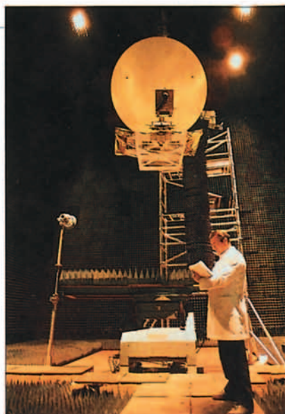
Antena DBS de "Hispatat" fabricada por CASA en calibración por el INTA.
