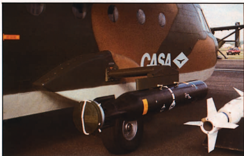
Para misiones de patrulla marítima, el C-212 puede ir armado con torpedos ligeros.
