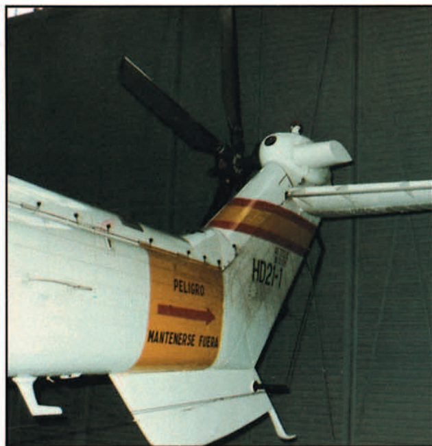
El rotor de cola lo conforman cinco palas de materiales compuestos, articulados en batimiento y cambio de paso conjunto.
