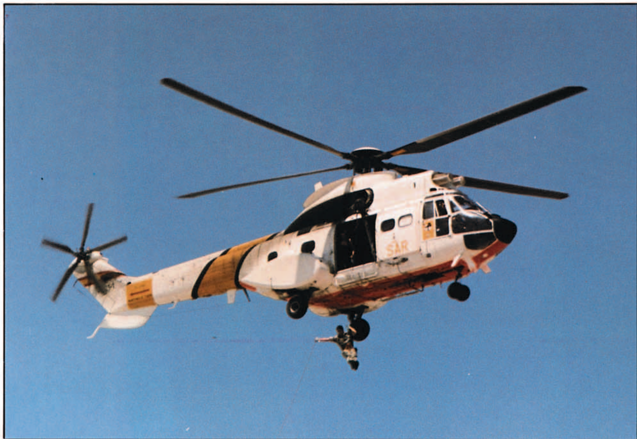
Los Superpuma del SAR van equipados de una grúa para poder realizar adecuadamente sus misiones de rescate.
