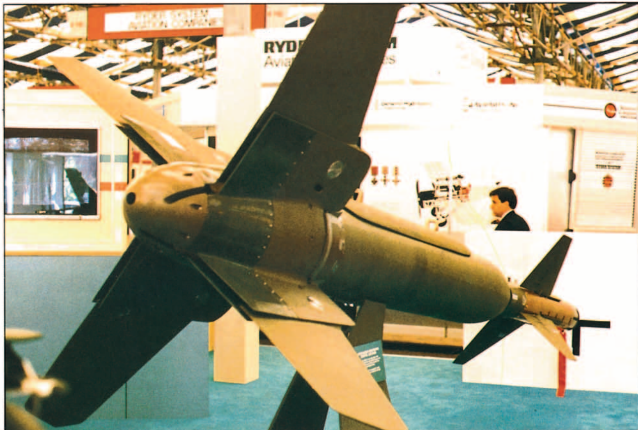
Bomba de guiado laser GBU 24 A/B (TEXAS INSTRUMENTS) con cabeza de guerra de gran penetración.
