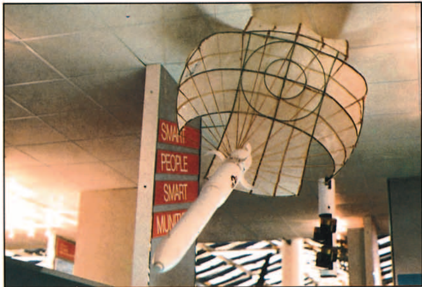
Submunición BLU-108/B del CBU-97/B con cuatro cabezas de guerra SKEET.
