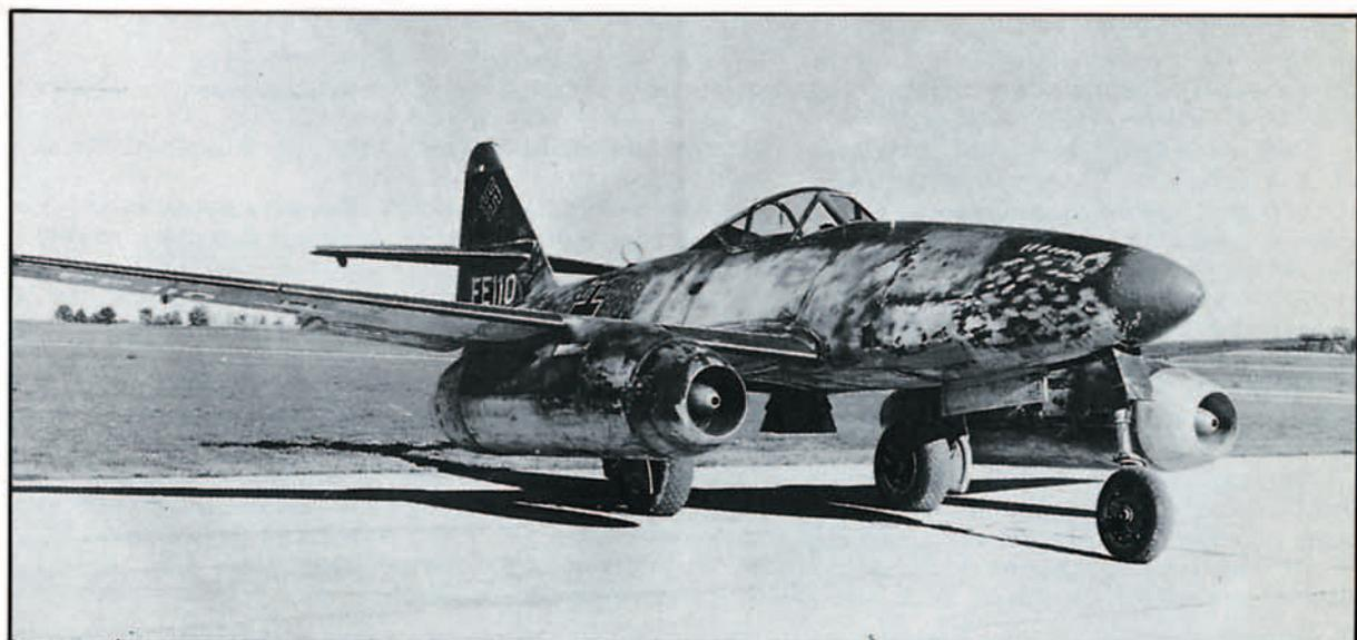
Figura 11. Bimotor Messerschmitt Me 262. Voló propulsado por motores de pistón entre el 4 de abril de 1941 y el 18 de julio de 1942, que lo hizo con turborreactores Jumo 004B, de compresor axial y 900 kg. de empuje cada uno.
