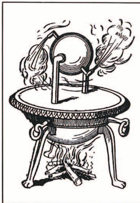
Figura 1. Máquina de Hero, invención del año 120-130 antes de J.C.
