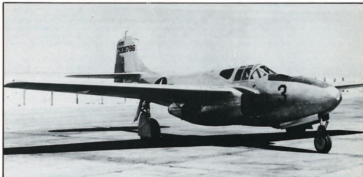
Figura 10. Avión Bell. XP-59A Airacomet con motor G.E.-IA. Año 1942.
