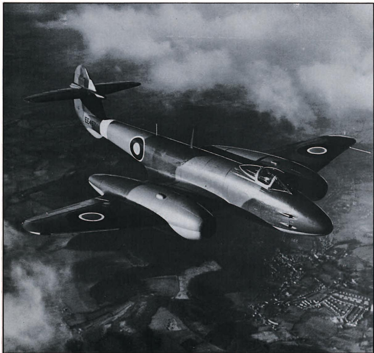
Figura 16. Avión Gloster Meteor, propulsado por motores W2 Welland, de Rolls Royce. Año 1944. Estos aviones fueron los únicos, de los Aliados, que propulsados por reacción intervinieron en la Segunda Guerra Mundial.
