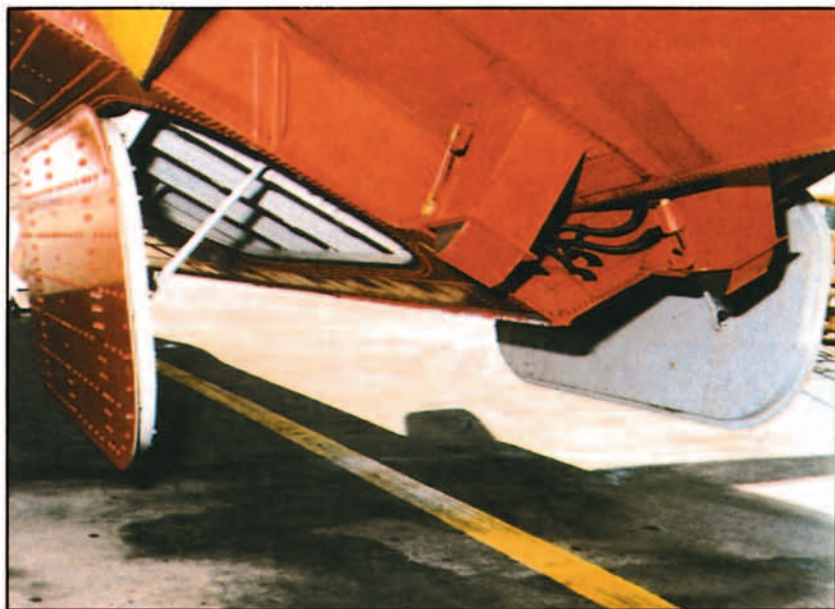
Compuertas del depósito del agua dispuestas para el lanzamiento.
