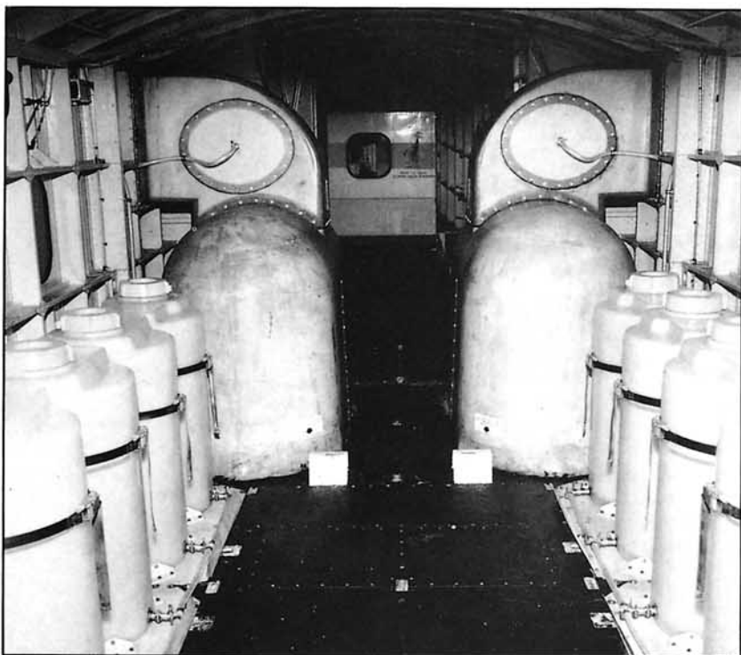
Depositos de espuma concentrada y distribución general del sistema mixto de espuma química en el CL-215.
