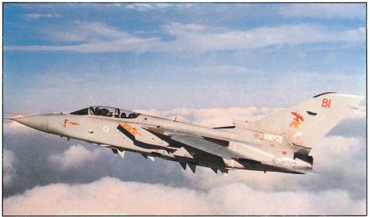
Se han fabricado más de 197 ejemplares de la versión de Defensa Aérea (ADV) del Tornado, equipados con misiles SKY FLASH de guía semiactiva y AIM 9L de guía infrarroja.
