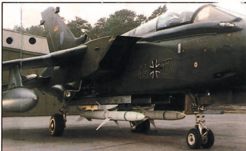
El armamento básico del Tornado E.C.R. consiste en dos misiles antirradiación tipo HARM AGM-88, que se transportan en lanzadores situados debajo de los planos.
