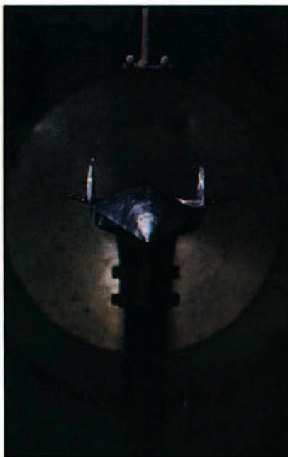
Modelo montado en túnel supersónico para su ensayo.
