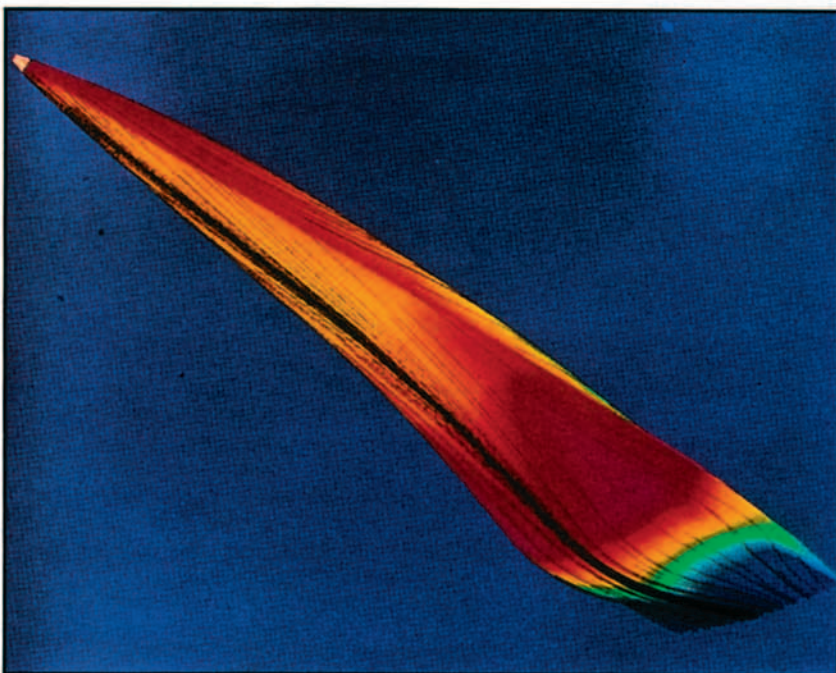
Simulación de la distribución de presiones alrededor de un modelo de X-30 volando a 25 de Mach. El rojo significa las zonas de alta presión (donde debe ir situada la entrada de aire para la planta propulsora) y azul la de baja presión (donde se sitúan las toberas de escape). Según el director del programa, Robert R. Barthelemy, las exigencias de simulación para el NASP están absorbiendo alrededor del 60% de la capacidad de los supercomputadores en USA.
