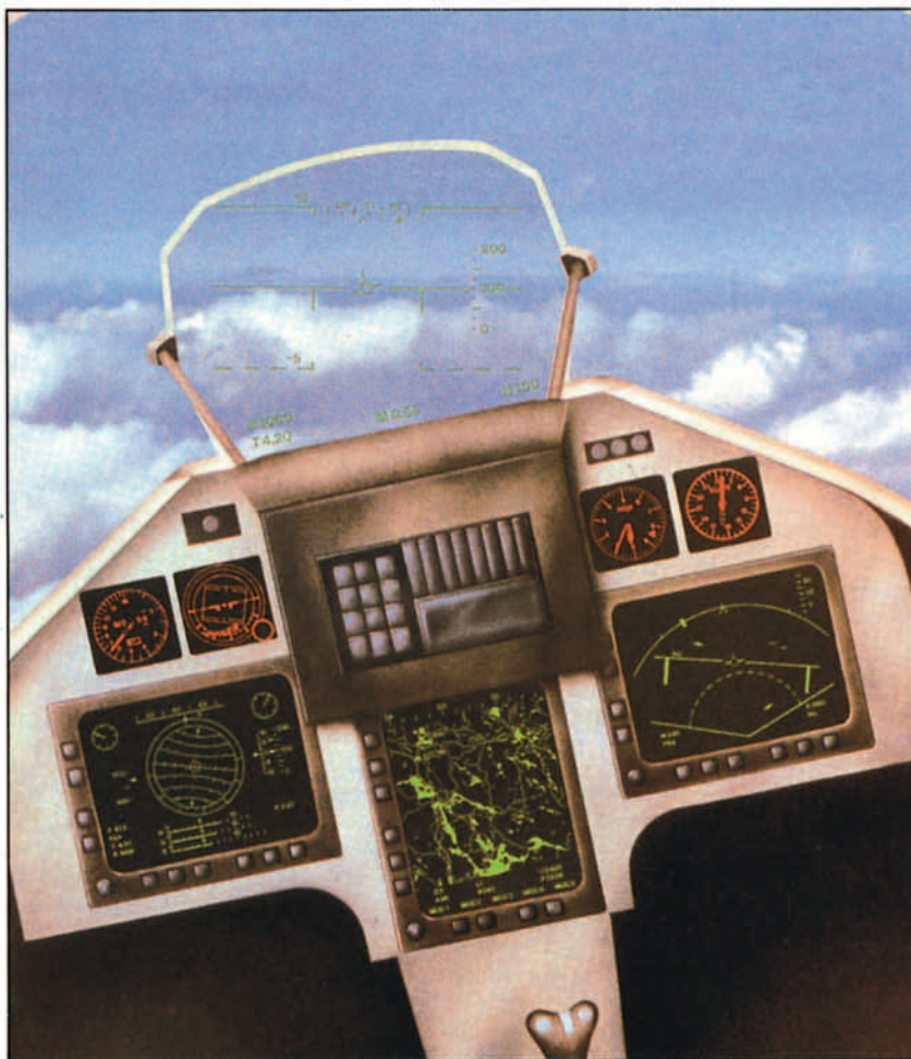
La moderna cabina del JAS 39 incorpora tres pantallas policromas multimodo y un HUP gran angular.
