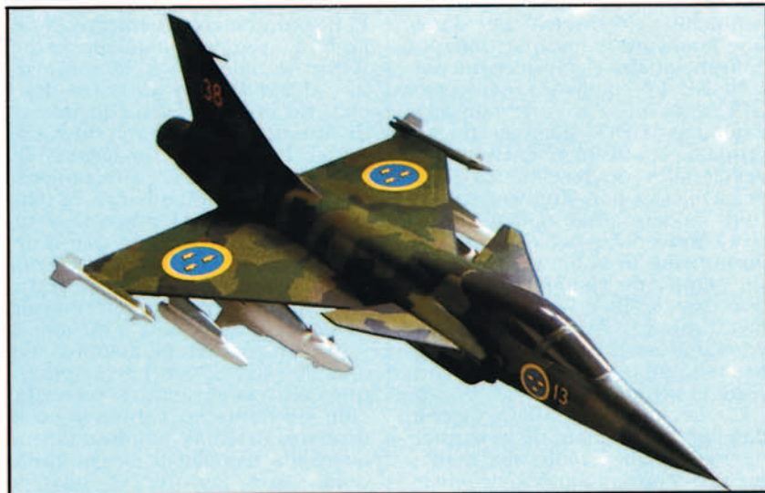
En la versión de interceptación marítima, el Gripen llevará el misil antibuque RBS 15.
