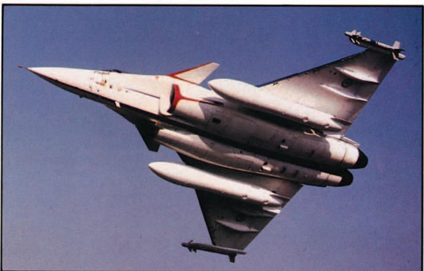
Configuración 2 MAGIC y dos tanques de 2000 lts.
