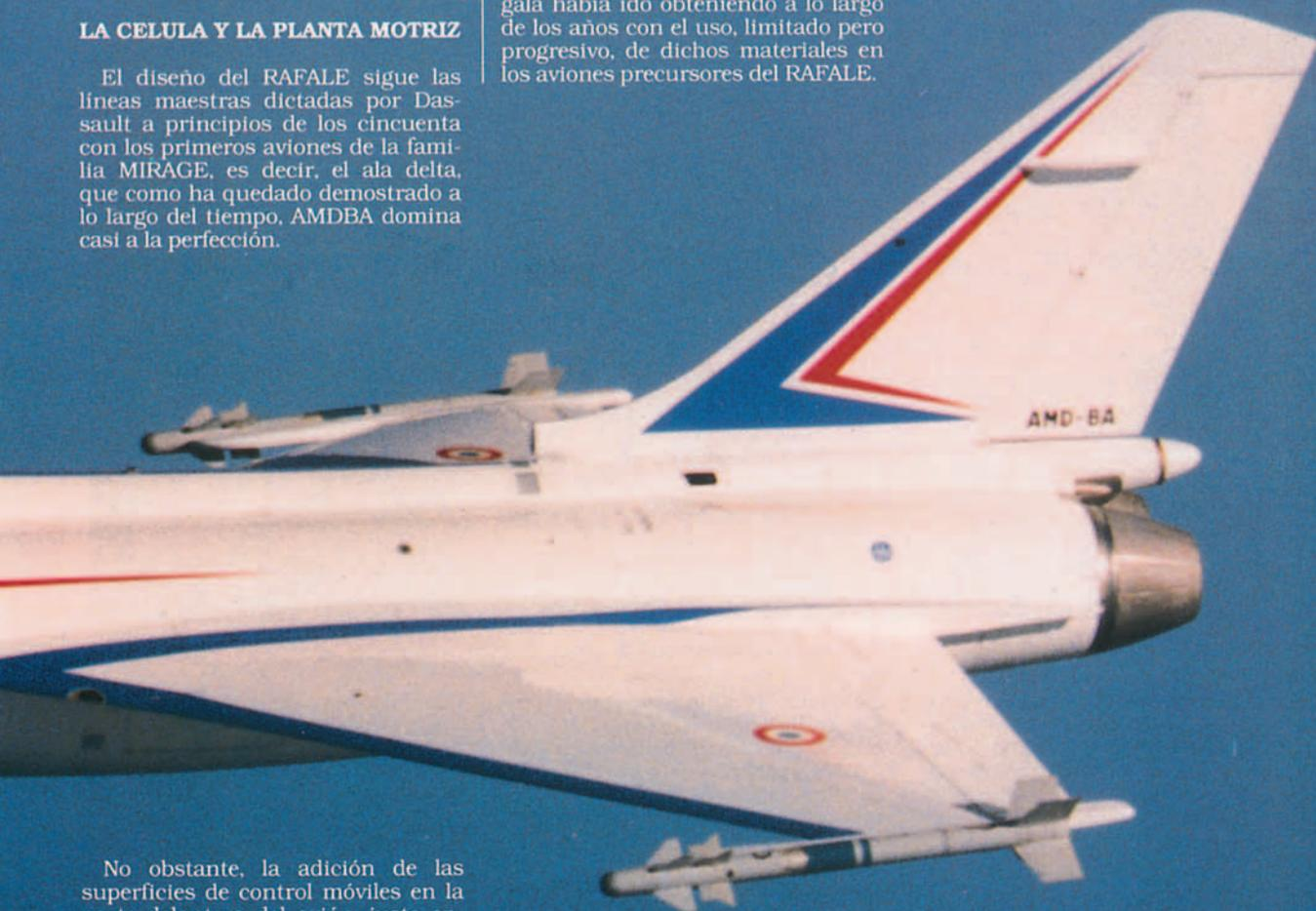
No obstante, la adición de las superficies de control móviles en la parte delantera del avión, justo encima del borde de ataque del plano (Canards activos), junto con las de hipersustentación tanto en el borde de ataque como en el de salida, y todo ello integrado a través del Sistema de Control de Vuelo Electrónico, le proporcionan al avión una capacidad de maniobra y una agilidad, dentro de su dominio de vuelo, difíciles de igualar.
