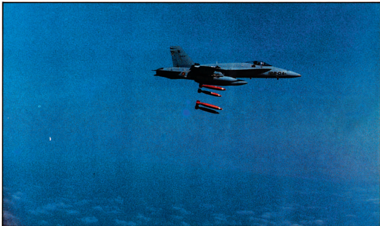
Durante 1987 el Ala 54 ha procedido a la homologación de bombas tipo BR500 y BR250 en el C-15 utilizando lanzadores tipo TER y directamente fijadas a la barquilla "PYCON" del avión.
