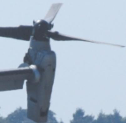
infiltración y exfiltración: seguimiento del terreno, baja altura, alta velocidad, largo alcance y despegue/aterri-zaje vertical. En palabras del teniente general Michael W. Wooley, jefe del AFSOC, “el CV-22 tiene la capacidad de volar a velocidades de turbohélice como el C-130 Hércules, transformarse en helicóptero y aterrizar como un MH-53J/M *Pave Low*”.
