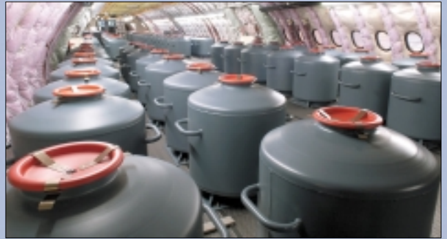
EL CONTROL DEL CENTRADO DEL A380 MSN001 DURANTE LOS ENSAYOS SE REALIZA MEDIANTE DEPOSITOS DE AGUA, LLENADOS SEGUN NECESIDADES, Y DISTRIBUIDOS A LO LARGO DE LAS DOS CABINAS DEL AVION. EN LA FOTOGRAFIA SE PUEDEN CONTEMPLAR UNA PARTE DE LOS DEPOSITOS SITUADOS EN LA CABINA SUPERIOR.
