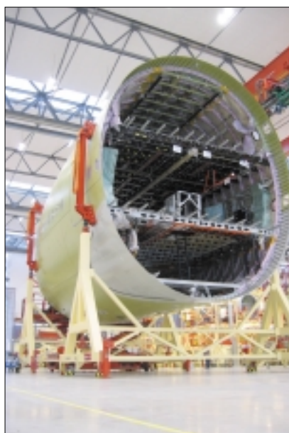
ESTA FOTOGRAFIA, DE UNA SECCION DEL FUSELAJE DEL PRIMER PROTOTIPO CONSTRUIDA EN HAMBURGO, PERMITE APRECIAR EL CONCEPTO DE SU CONFIGURACION ESTRUCTURAL. LA SECCION ES LA CORRESPONDIENTE A LA ZONA SITUADA INMEDIATAMENTE DELANTE DEL ALA.
