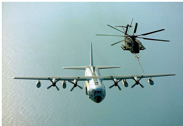
Foto 6. C-130 de la USAF ya poseen "pod" de reabastecimiento de baja velocidad ideal para el "refueling" de helicópteros.
