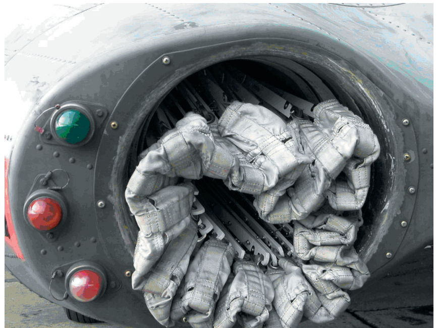
Detalle del pod de reabastecimiento del C-160. Obsérvese las diferencias con el sistema de luces del C-130.
