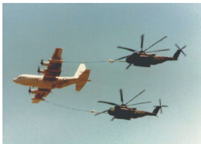
Foto 6. C-130 de la USAF ya poseen "pod" de reabastecimiento de baja velocidad ideal para el "refueling" de helicópteros.
