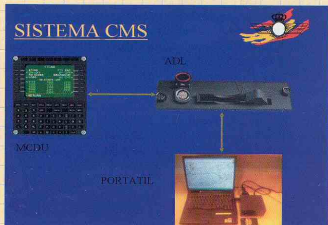
Gráfico 4. Sistema CMS. Observamos la interfaz MCDU(hay 2 en cabina, 1 para el piloto y otra para el copiloto), el cargador/descargador ADL y el portátil con su adaptador y disquete(común con el Sistema de Planeamiento de misión MPS).
