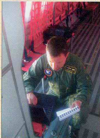
Gráfico 3. Mecánico auxiliar de vuelo realizando la descarga de datos y comprobando los fallos con el manual del motor y hélice.
