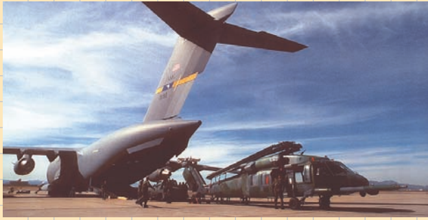
Arriba, C-130 efectuando un lanzamiento LAPES (Low Altitude Extraction System). Abajo, C-17 cargando un helicóptero HH-60G, puede llevar hasta dos.
