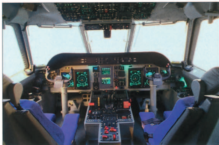
Cabina del T-21. Se aprecia en el pedestal las palancas únicas de control y las 2MCDU que gestionan el sistema integrado de aviónica. En el panel frontal se encuentran las PFD y ND (pantallas grandes) y las pantallas pequeñas de control y potencia.
