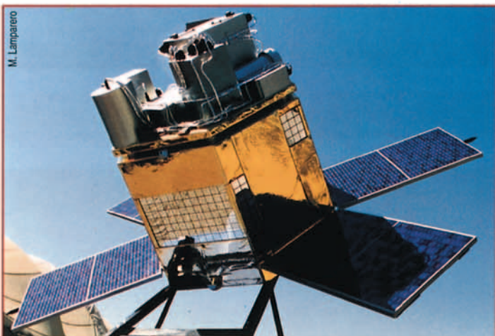
MAQUETA DEL MINISAT 01- El Minisat 01 es una plataforma multipropósito dentro del segmento de los minisatélites (masa comprendida entre 100 y 1000 kg). Entró en servicio en abril de 1997 con tres instrumentos científicos y un demostrador tecnológico. El Minisat 01 estudia la radiación difusa del medio interestelar galáctico en el extremo ultravioleta siguiendo un experimento diseñado por un equipo compuesto por el INTA y la universidad de Berkeley (EEUU). Otro experimento a bordo del Minisat 01 es el comportamiento de puentes líquidos en microgravedad y está patrocinado por la Universidad Politécnica de Madrid. También estudia nuestro satélite la radiación gamma de baja energía según un programa desarrollado por un equipo científico internacional compuesto por la Universidad de Valencia, el INTA, el CIEMAT, las universidades de Birmingham y de Southampton y el Rutherford Appleton Laboratory del Reino Unido. Finalmente, el Minisat 01 estudia también el comportamiento en órbita de un nuevo diseño de regulador de velocidad para despliegue de grandes reflectores y mástiles desde satélites desarrollado por la División Espacio de EADS/CASA.
