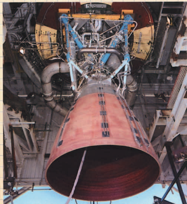
El motor RS-68 desarrollado por Boeing es la clave del desarrollo del lanzador Delta IV. Boeing
