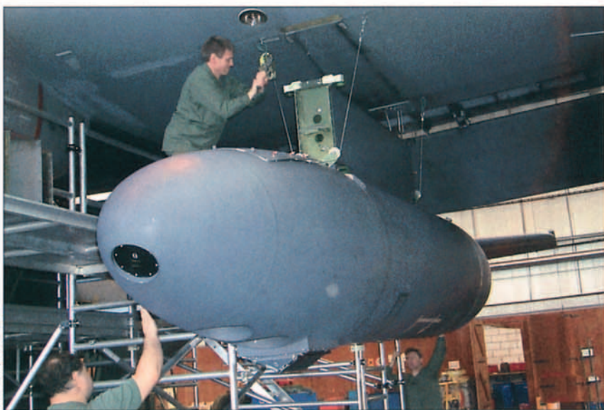
Instalando el pod de sensores en Melsbroek (Bruselas).
