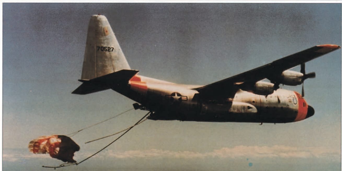
De regreso a casa: un aeroplano JC-130A modificado (que sustituyó a los C-119) podía recoger en vuelo la cápsula de los Corona, una vez finalizada su misión. (Foto: Lockheed Martin)
