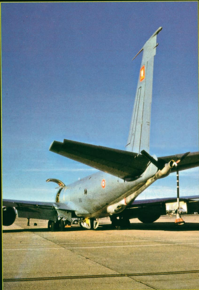
*En el extremo de la lanza de repostado se puede ver el BDA (Boom Drogue Adapter) que sirve para poder repostar a los cazas equipados con lanza, como el EF-18.*
