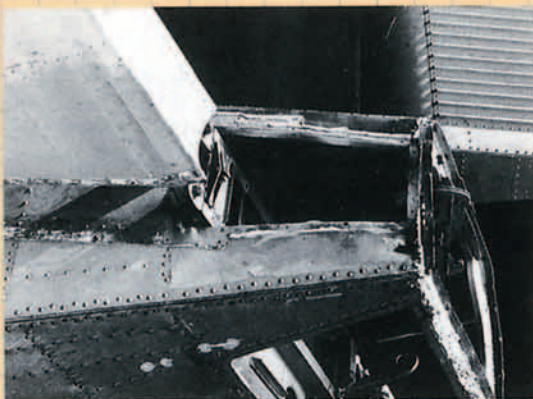
Detalle de los desperfectos de la cola del avión T.12B-24.
