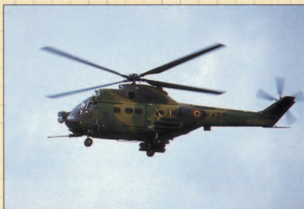
IAR-330L, un Puma dotado de armamento A/S y FLIR.
