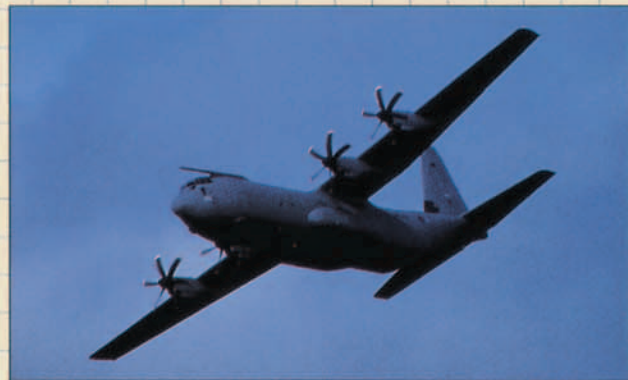
El nuevo Hércules "Julie" mostrando su hélices de seis palas.
