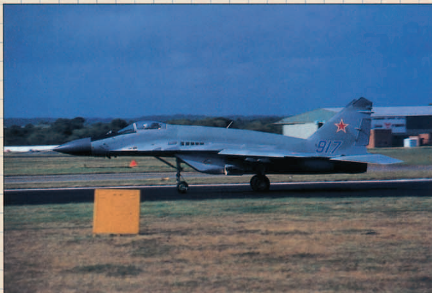
Mig-29 SMT en el que se aprecian las estrellas rojas y la nueva forma del fuselaje, destinado a albergar más combustible.
