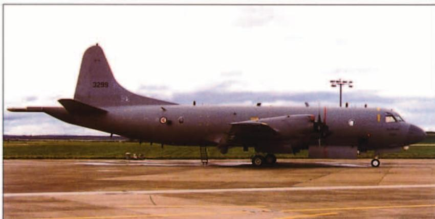
Vista lateral de un P-3C noruego recientemente modernizado, donde se observa la gran cantidad de antenas, que dan idea de la importancia que está adquiriendo la guerra antisubmarina (ASUW), donde los equipos ELINT y de autoprotección juegan un papel fundamental. (Obsérvese la antena omnidireccional detrás del tren principal).
