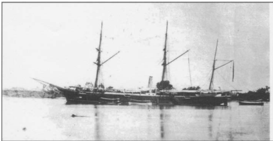
Corbeta de hélice Vencedora , con un desplazamiento de 750 toneladas, máquina de 160 c.v. nominales, que le proporcionaba una velocidad de 8 nudos, y un armamento de dos cañones lisos de 20 cm, en colisa y en el centro del buque, y uno liso en colisa y a proa. Fotografía del libro Buques de vapor de la Armada española . J. Lledó Calabug.
