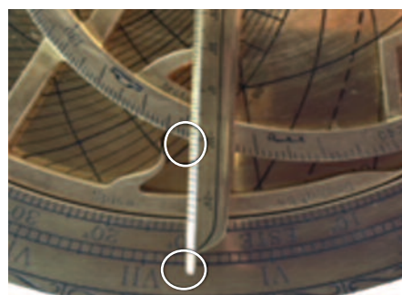
3. Giro de la araña hasta el horizonte, 06h. 40 min
