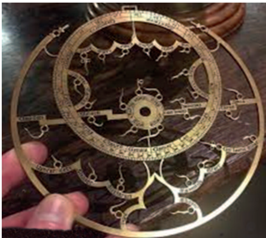
Fig. 7. Araña de 32 estrellas y eclíptica
