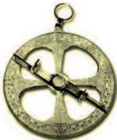
Fig. 16. Astrolabio náutico, máxima simplificación del astrolabio universal. Solo conserva de este la alidada de pínulas, para medir la altura de los astros
