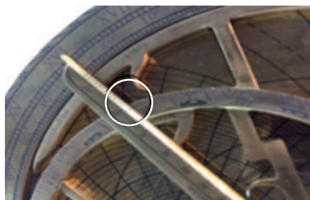
2. Traslado de la posición del Sol a la araña
