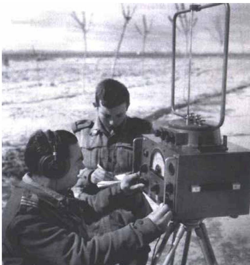
Radiogoniómetro Telefunken P-100, empleado hasta principio de los años 80 por la unidad de localización. Probablemente, antes de este modelo, se debió emplear el modelo de Telefunken P57N heredado de los empleados en la Guerra Civil española. (1986. Archivo del Centro de Análisis Técnico del E.T.)
