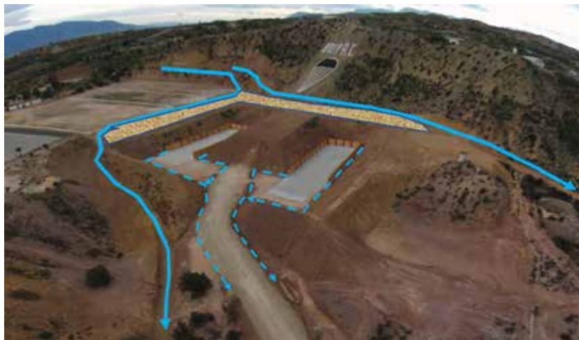
Esquema del sistema de evacuación de aguas
