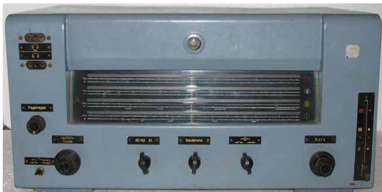
Receptor alemán TELEFUNKEN AE-1076. (Recuperado de www.nonstopsystems.com/radio/hellschreiber-mil-tx-rx.htm )
