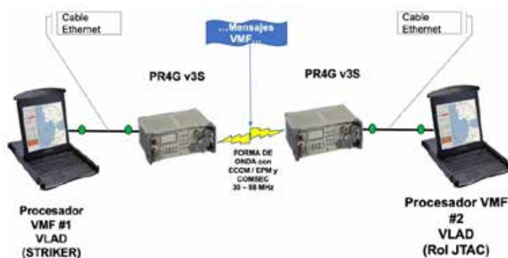
Esquema de la prueba de envío de mensajes VMF con radios PR4G v3S
