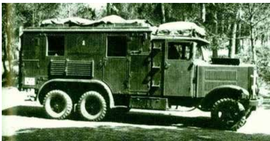
Camión "Telefunken". Durante la Guerra Civil existieron dos modelos en el bando "nacional", uno con receptores y otro con un perturbador. Al término de la guerra los receptores y los perturbadores se emplearon por parte del Centro de Transmisiones del Ejército para realizar tareas de escucha y perturbación.
