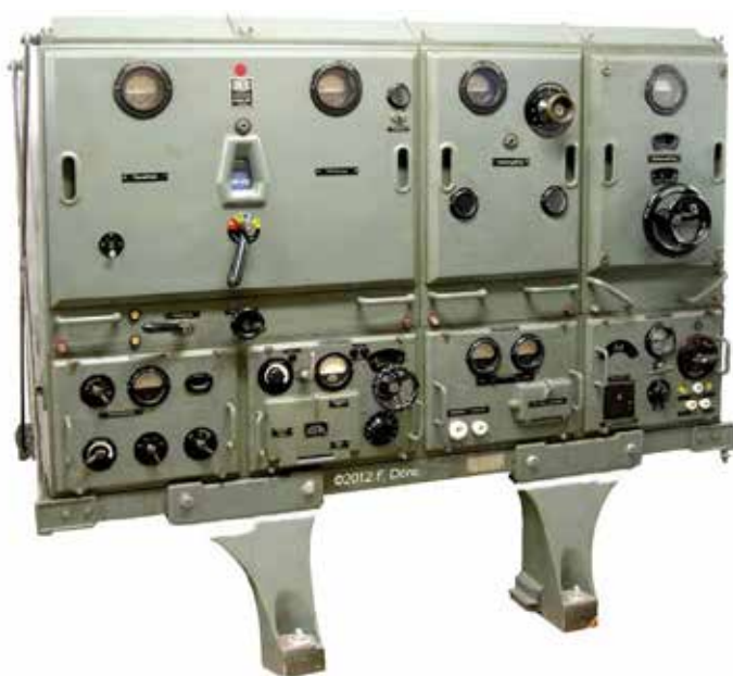
Interior del camión escucha "Telefunken" con receptores Spezial 445.
