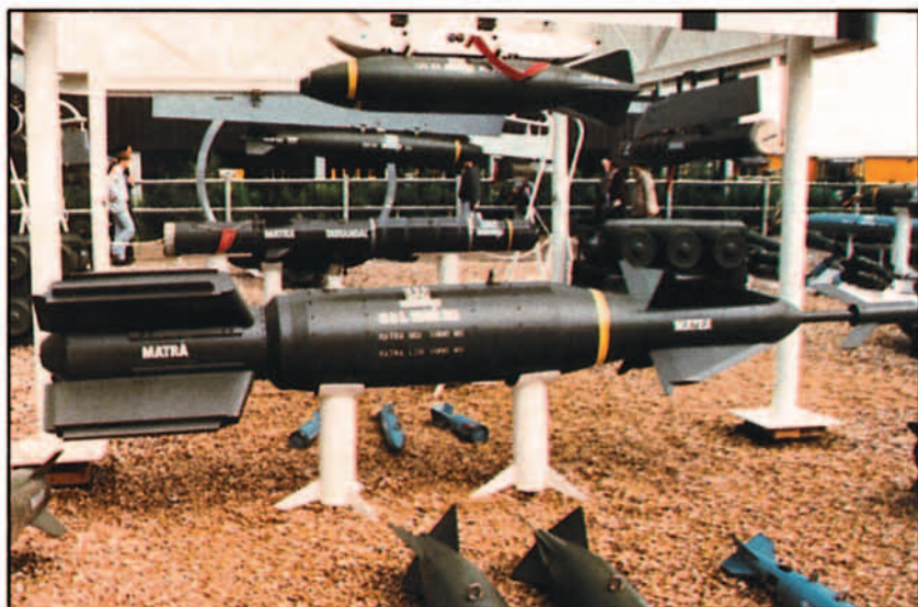
Bomba de 1.000 kg., guiado Láser de Matra
