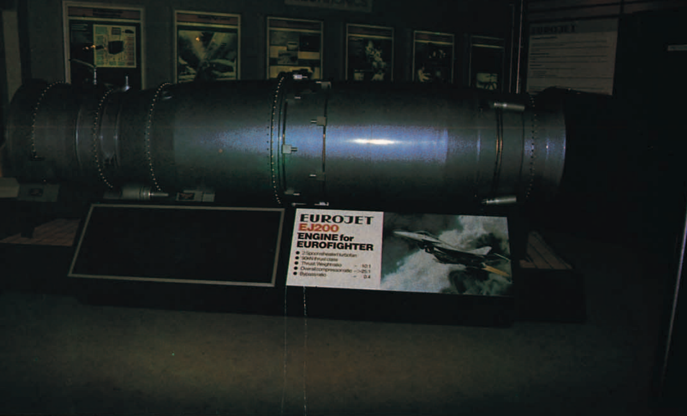
El motor del EFA, EJ200 de EUROJET, en el que la empresa española SENER es responsable de la tobera convergente/divergente, los difusores de salida y el conducto de derivación del "fan".
