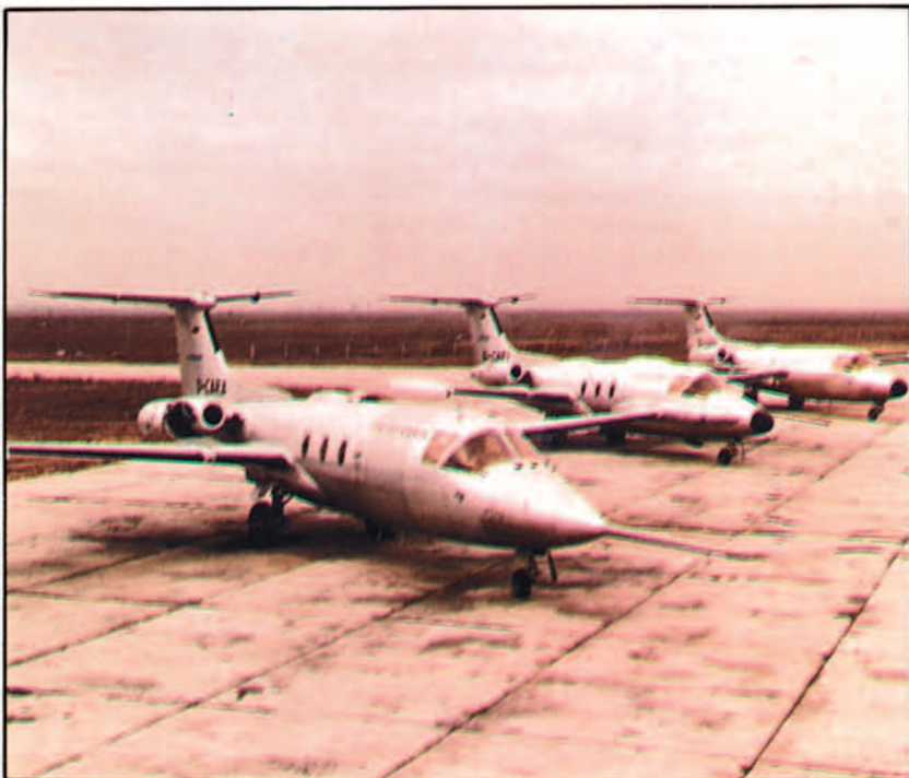
El HANSA JET HBF-330 de la Hamburguer Flugzeugbau (compañía que, desde 1969, forma parte del consorcio Messerschmitt - Bölkow - Blohm MBB) ha sido el único avión con flecha fabricado en cantidad (unas 45 unidades). El avión hizo su primer vuelo el 21 de abril de 1964 y aquí vemos a los tres primeros aviones en las instalaciones de la Hamburger.
