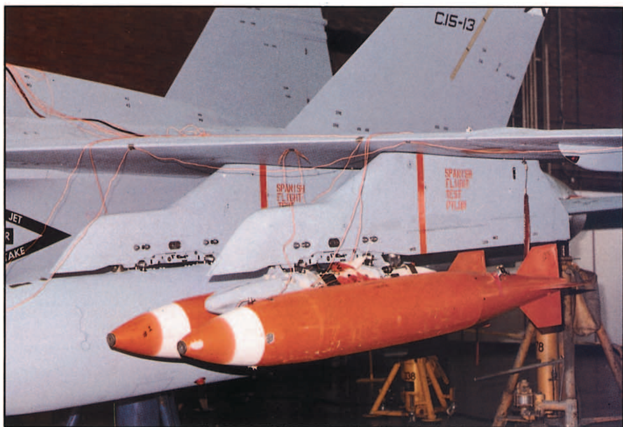
Dos BR-500 en TER durante los ensayos de vibración en tierra realizados en St. Louis.
