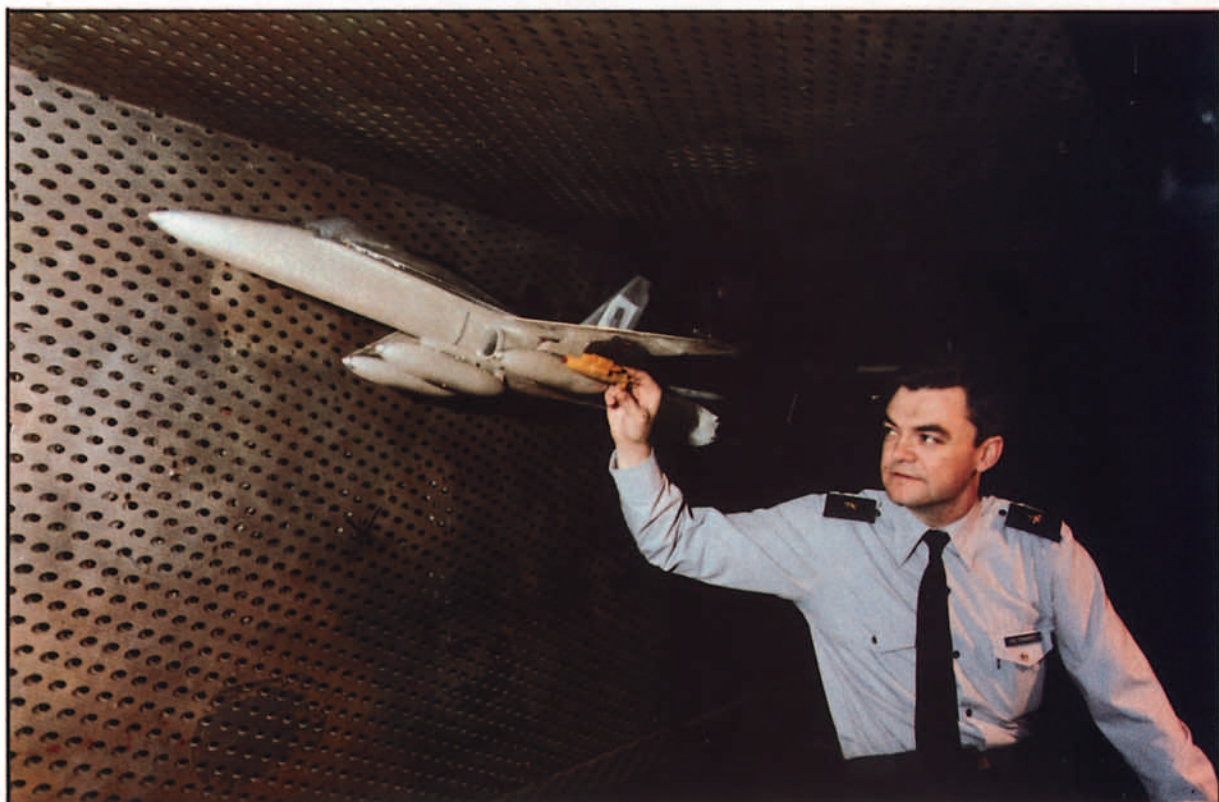
Ensayos en el túnel aerodinámico de ARNOLD (AEDC-USAf) de caída libre (lanzamiento de una maqueta de TER-9A modificado y una bomba BR-500).
