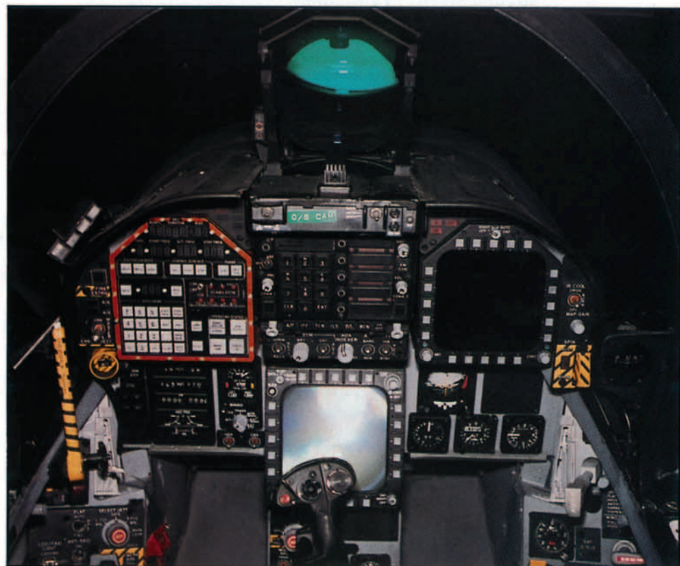
Cabina del F-18 con el FECU (Unidad de Control de la excitación del Flameo) situado en el ODI (Pantalla de Presentación Digital) izquierdo.
