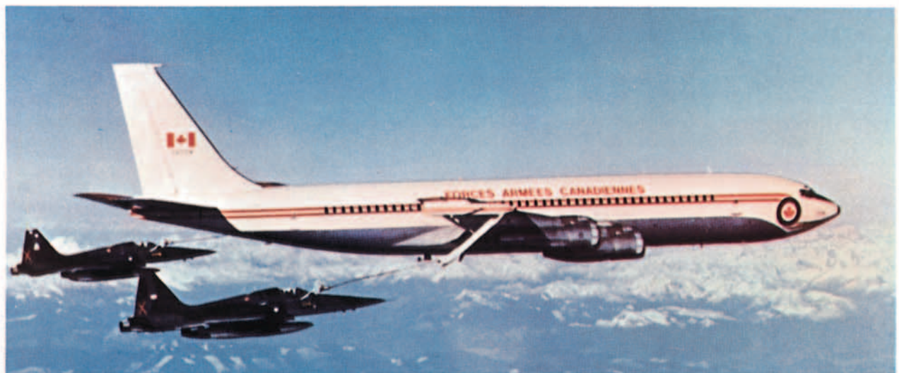
Boeing 707 de las Fuerzas Armadas Canadienses reabasteciendo en vuelo a dos F-5
