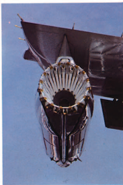
Detalle del dispositivo de reabastecimiento en la punta del ala de un Boeing 707
