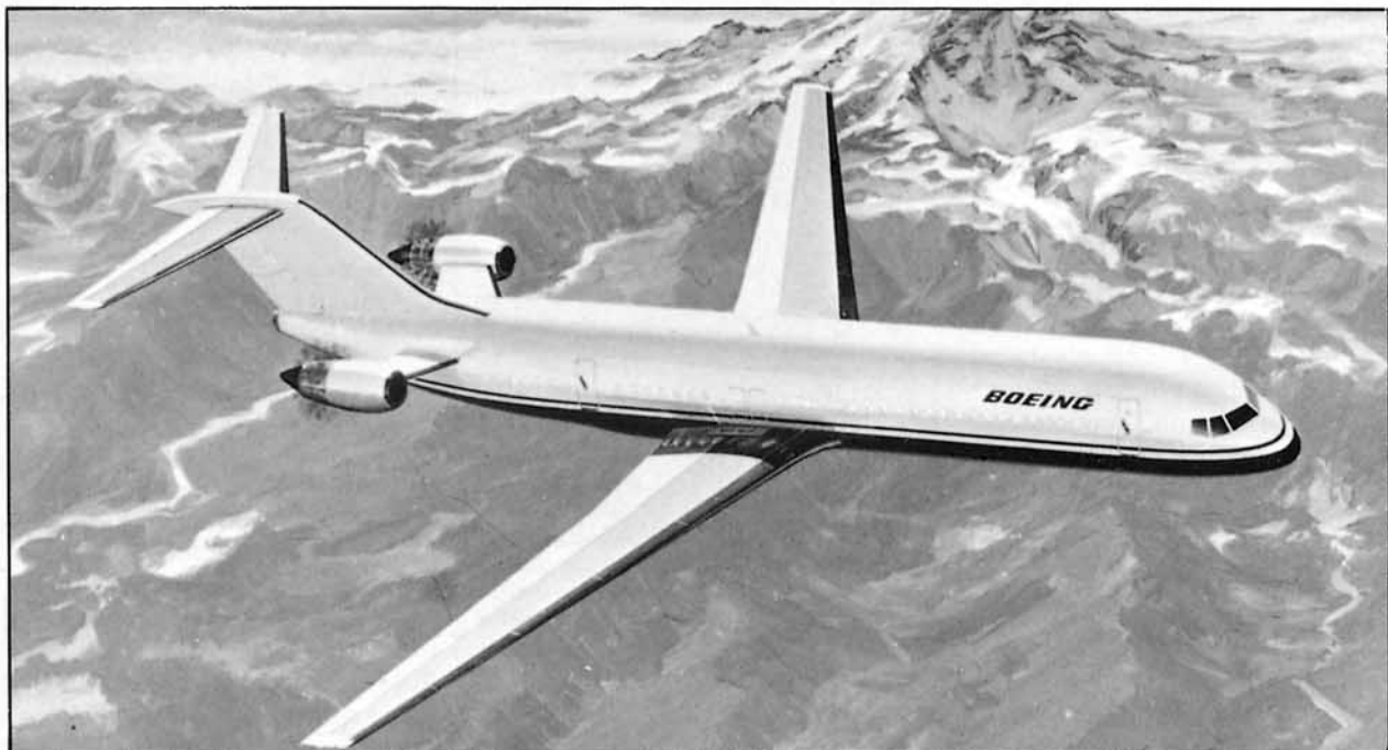
En la "Royal Aeronautical Society" de Londres, el vicepresidente de Boeing Commercial anunció, para 1992, un avión de 150 plazas, que podría llevar dos sistemas propulsores de hélices transónicas, que Boeing llama "Ultra Bypass Engines"
