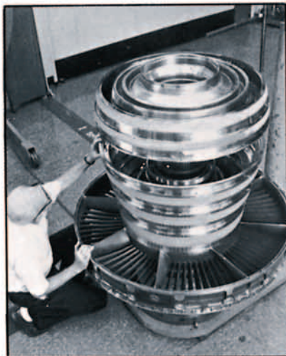
Un técnico de la General Electric procede al montaje del F-404, que será el generador de gas para el propulsor de hélice transónica UDF. El F-404 tiene 11.340 kg. de empuje
