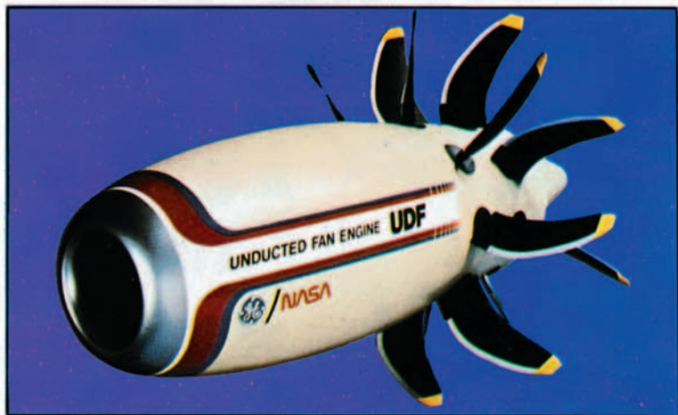
El UDF (ventilador descarenado) de General Electric. Fórmula atrevida y elegante, con turbina libre, sin caja de engranajes y la tobera de escape de los gases en la parte posterior de los rotores
