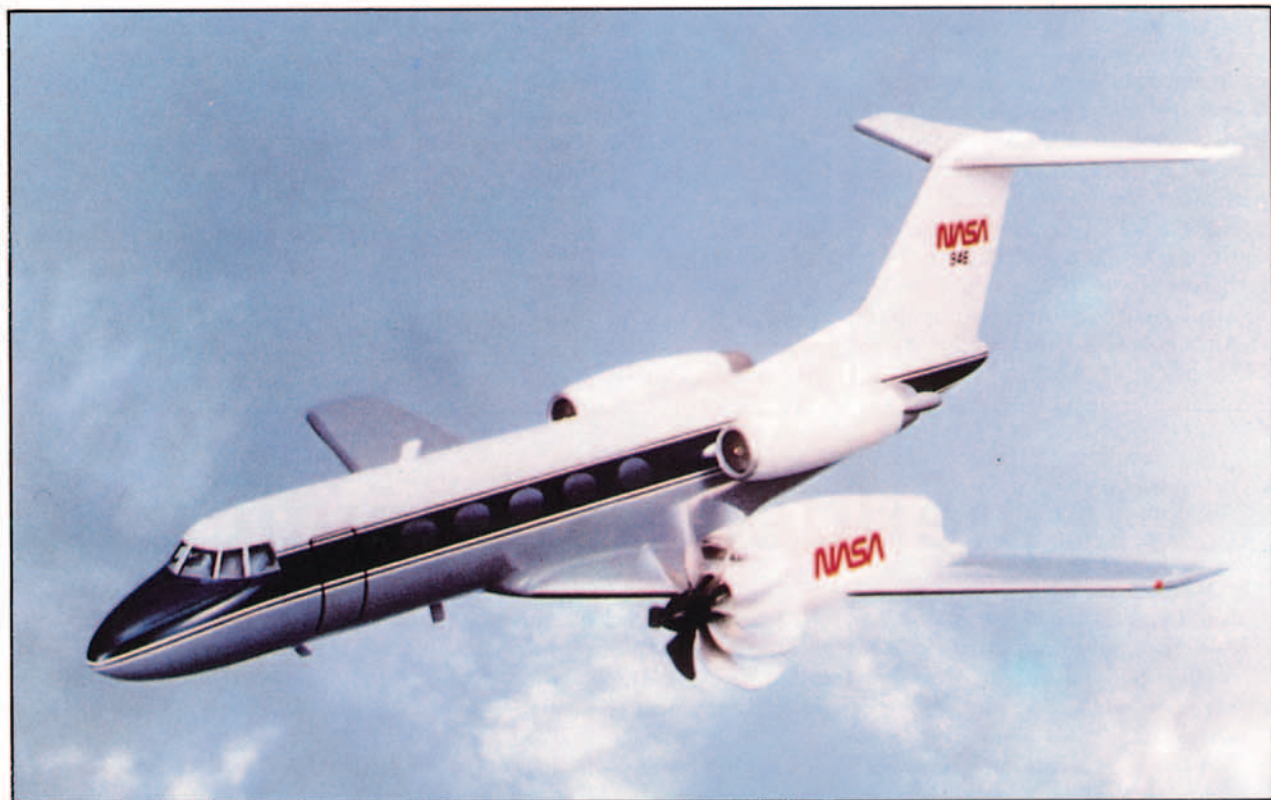
Avión Gulfstream-II, con hélice propfan tractora en su plano izquierdo, que volará en 1987 de acuerdo con el programa PTA de la NASA dirigido por la Lockheed. La hélice de ocho palas es de Hamilton Standard y el motor 501-M78 es de Allison
