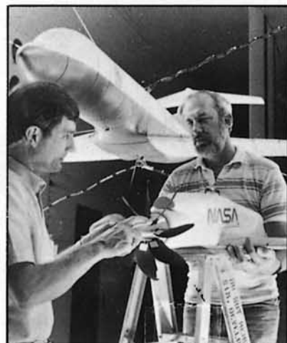
Maqueta del Allison 501-M78 con propfan, en primer plano y la del Gulfstream-II al fondo
