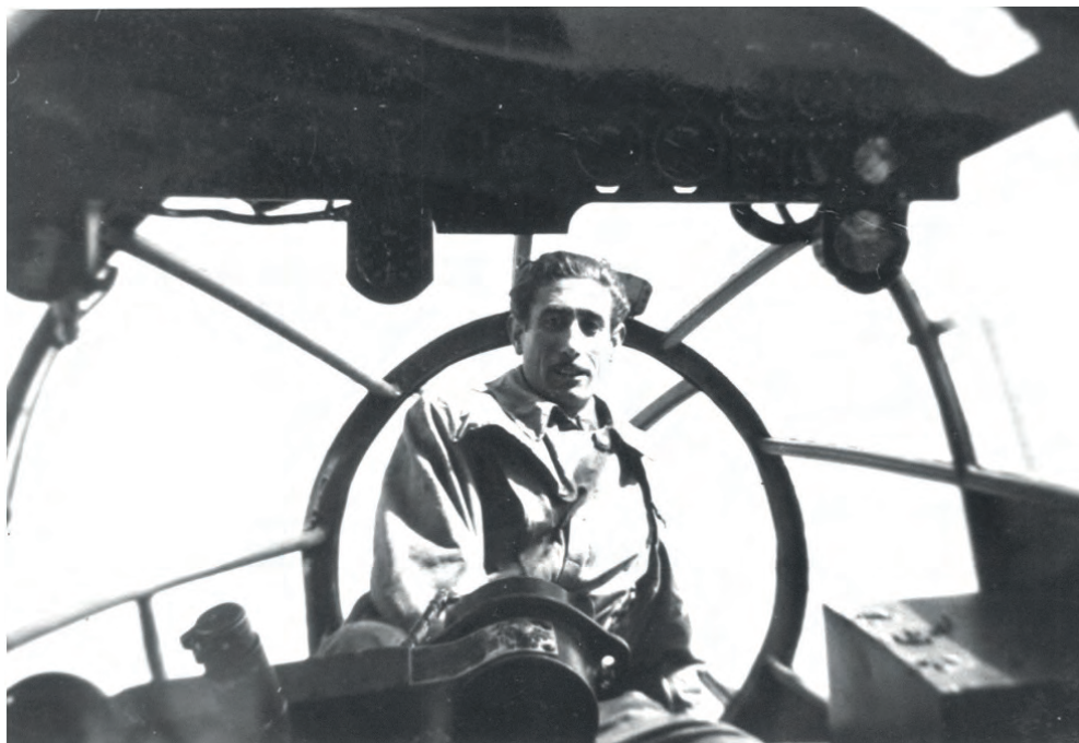
Vista interior de la cabina de vuelo del He 111 H. Se observa la columna de mandos de vuelo con el brazo basculante desplazado a la izquierda, en posición para el piloto. Al fondo, la cúpula acristalada con la "icaria" o punto de anclaje donde iba situada una ametralladora MG 15 de 7,92 mm del artillero de proa en la versión de bombardero. (Foto de Ángel de las Heras)
