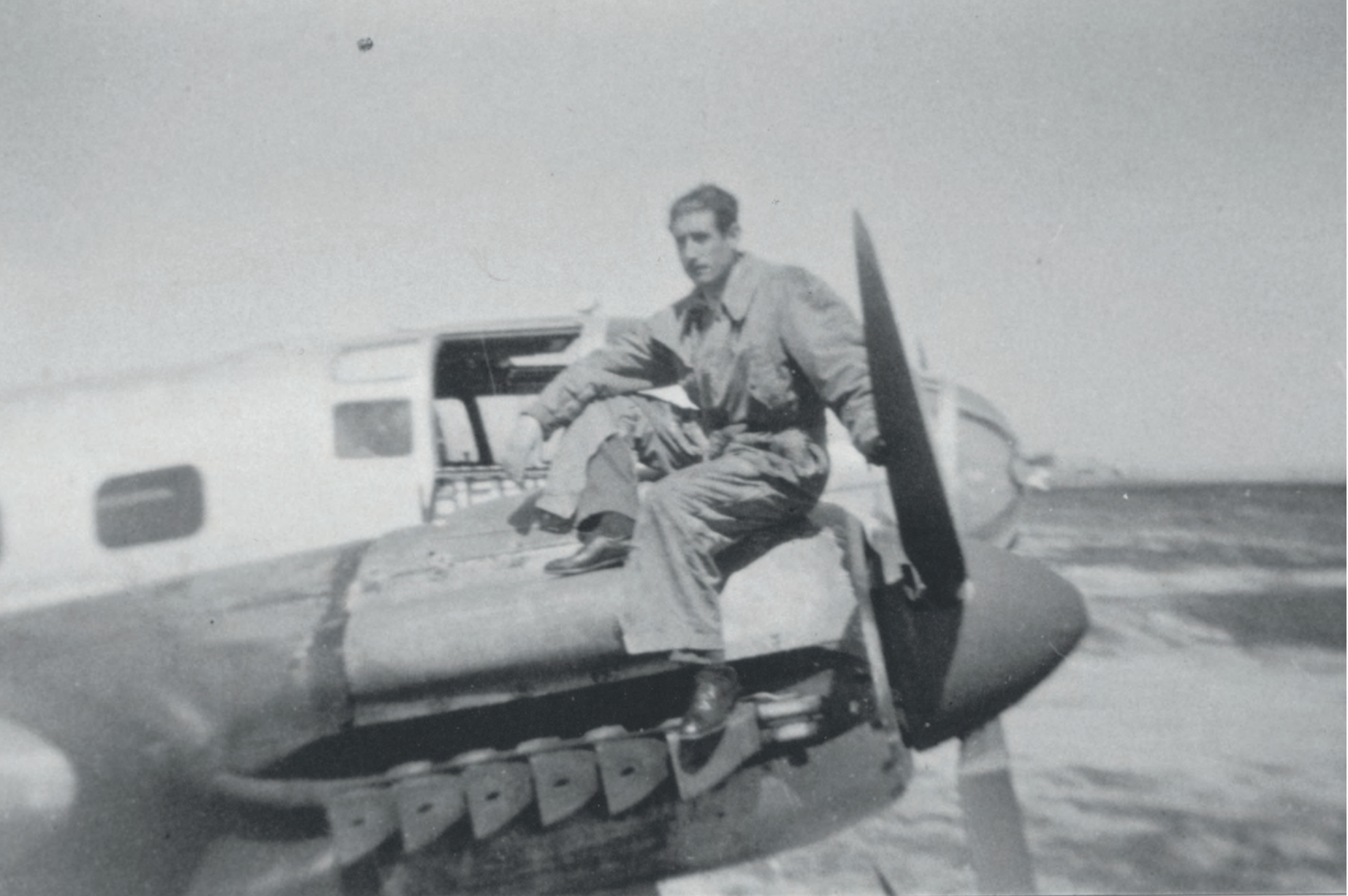
El sargento de las Heras sentado sobre el motor derecho del He 111 "Toledo", un Junkers "Jumo" 211 F, de 12 cilindros en "V" invertida (1300 CV) y pintado de negro. Obsérvese, bajo la ventanilla abierta de la cabina, parte del anagrama de "Iberia". (Foto de Ángel de las Heras)
