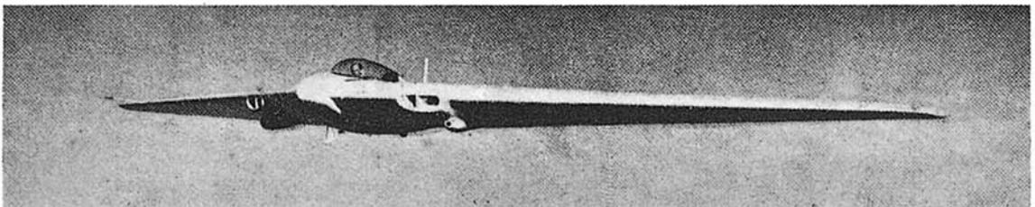
*Uno de los cuatro N9-M, construídos y ensayados para estudiar las futuras características de vuelo y funcionamiento del XB-35.*
