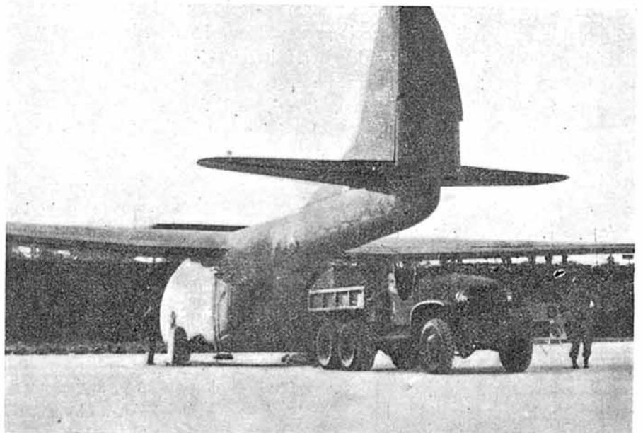
*El "XCG-10" carga por unas puertas en la cola del fuselaje.*
