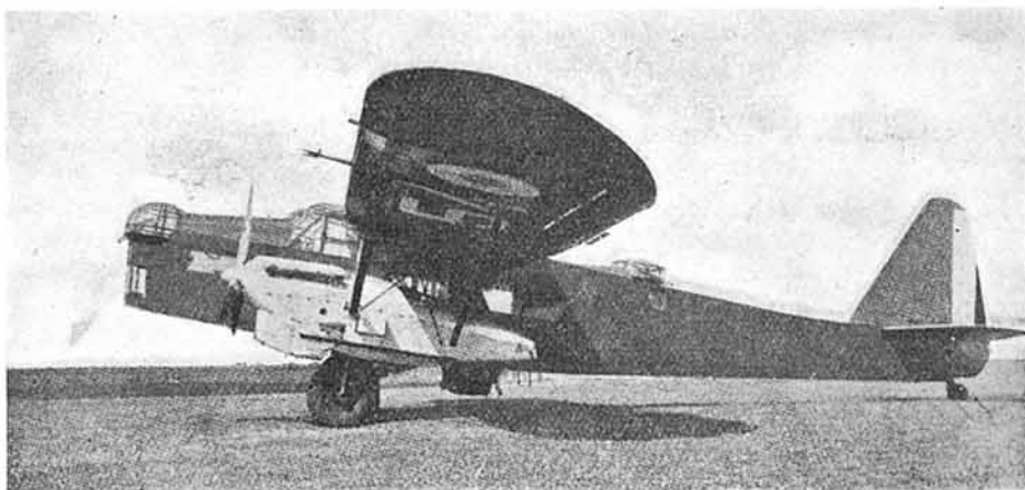
Un abuelo de las "fortalezas volantes", el "Potez 54" (1934), con torreta a proa y otras que batan los sectores superior e inferior, 240 kms. de velocidad de crucero y una carga de cuatro bombas de 200 kgs.
