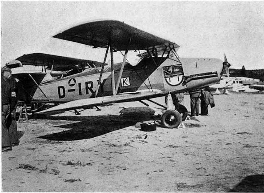
Biplano Arado 66 C, con motor Argus de 220 cv., uno de los tipos que mejor se ha comportado en la dura prueba.
