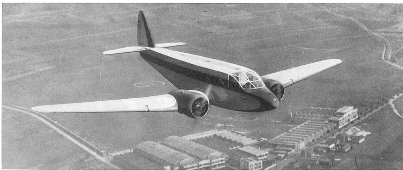
Una vista en vuelo del nuevo bimotor ligero de transporte Potez 56, con tren plegable y construido enteramente en madera. Sus performances, con dos motores Potez 9 Ab de 185 cv. y peso total de 2.475 kilogramos, son las siguientes: velocidad máxima, 270 kilómetros por hora; ídem de crucero, 235 kilómetros por hora; techo absoluto, 6.000 metros; radio de acción, 650 kilómetros. Con un solo motor: velocidad a 500 metros, 180 kilómetros por hora; techo absoluto, 1.500 metros.
