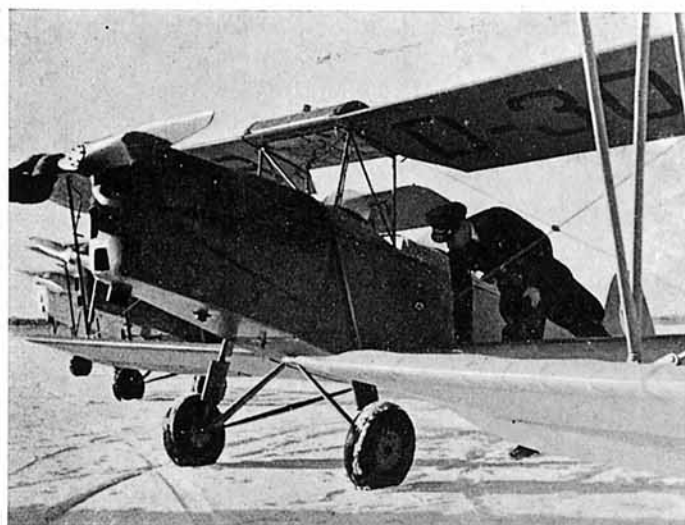
Biplaza alemán para escuela y deporte Adler. Estructura completa de acero. Lleva motor Hirth de 60/70 cv.
