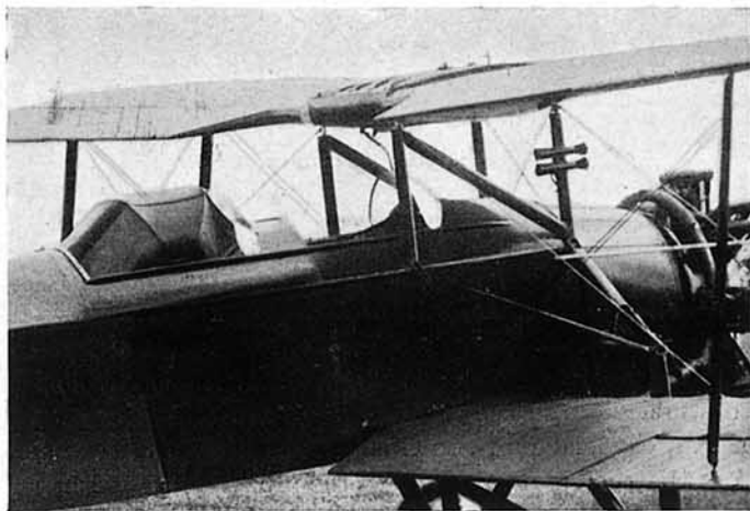
El avión S. V.-26-Lynx, con la cabina posterior de pilotaje equipada para la enseñanza del vuelo sin visibilidad.
