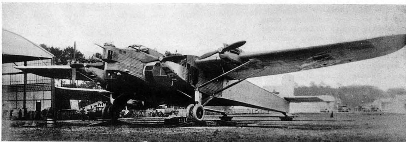
El cuatrimotor A. B.-20, producido por la Société Générale Aéronautique , provisto de cuatro motores Lorraine de 600 cv. Su armamento defensivo poderoso, su gran capacidad de carga (2.500 kgs. de bombas) y sus altas performances, permiten calificarlo como avión de Armada Aérea .
